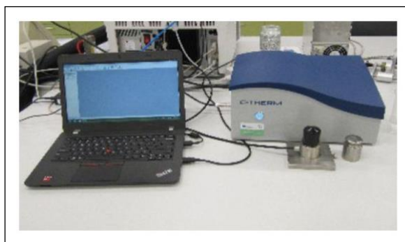
Figure 10 : Système d'analyse thermique DSC (C-Therm) connecté à un ordinateur pour l'enregistrement des données thermiques.
