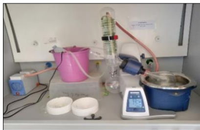
Figure25: Récupération du méthanol par le rotavap.
