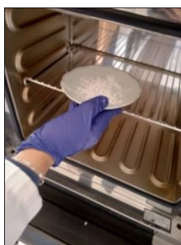
Figure 23 : séchage thermique du polymère.
