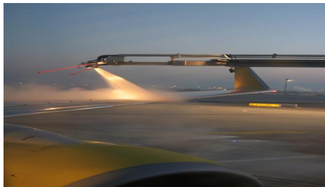
Figure 1. 1. Dégivrage au sol [1].
