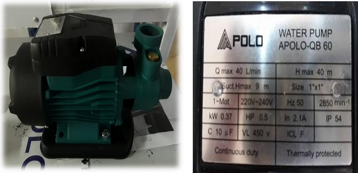
Figure IV.5: Pompe et sa caractéristique
