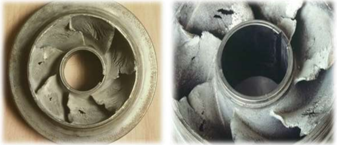
Figure III.1: Phénomène de cavitation [30]
