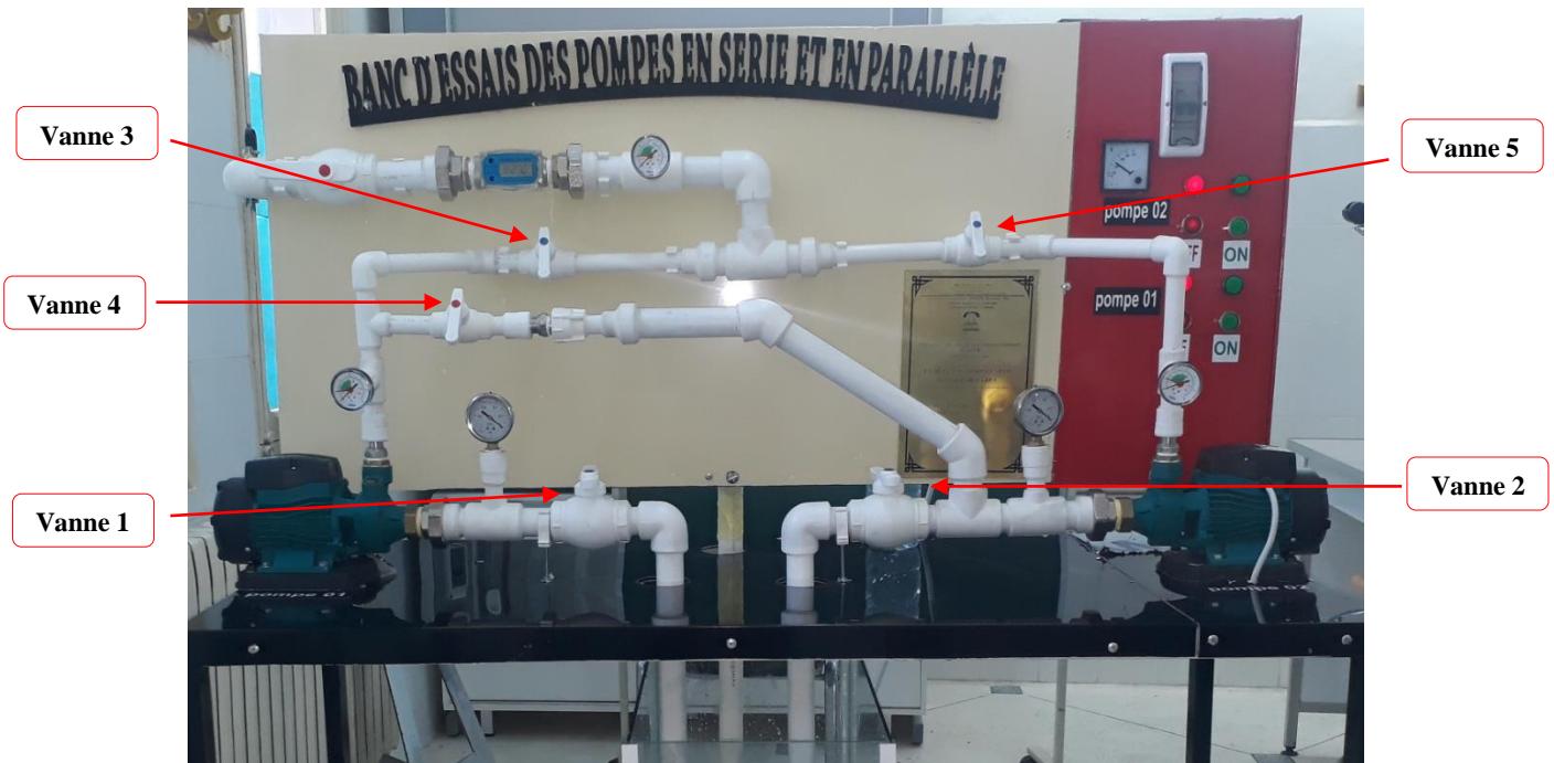
Figure IV.25 : Schéma de fonctionnement des vannes
