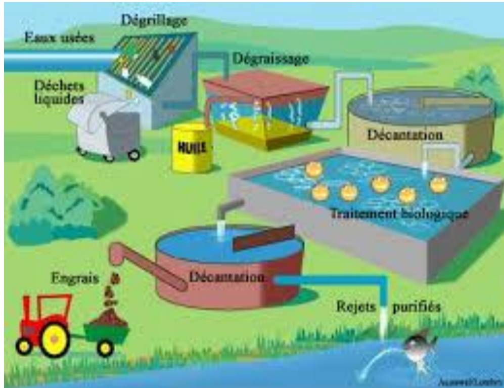
Figure 1:schéma synoptique de station d'épuration.
